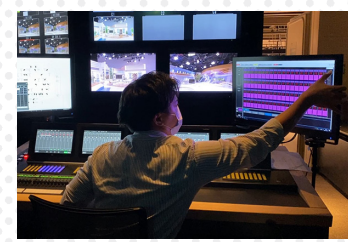
六本木本社スタジオと神谷町スタジオの照明設備を相互に遠隔で制御可能にしたリモートプロダクションシステム
